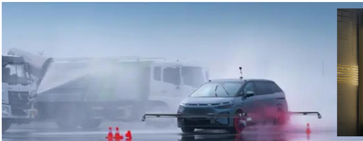
タイヤバースト時の安定性試験シナリオのデモンストレーション。
